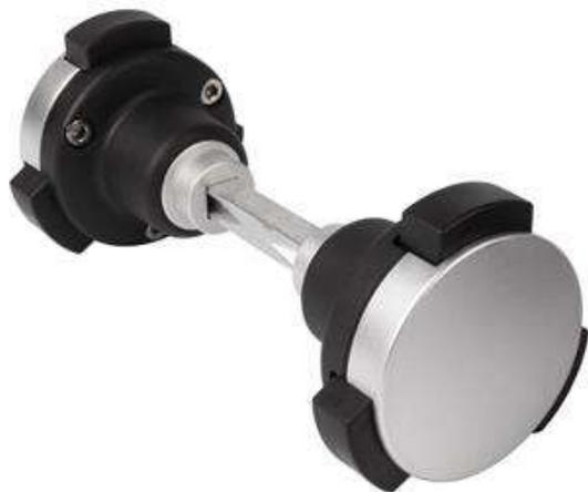
Bouton de sécurité en polyamide et en aluminium anodisé. Evite l'accès aux enfants, il est nécessaire d'appuyer un ergot minimum et de tourner, double action simultanée. Conforme à la norme de sécurité piscine Française NF P90-306.
